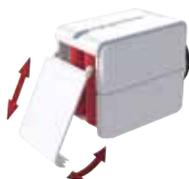
Stella Z fährt in die Montageposition. Verwenden Sie keine Akkus! Achten Sie auf die richtige Polarität! Wir empfehlen den Gebrauch von Alkaline-Batterien.
